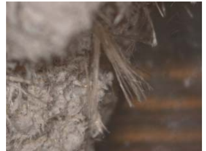
Figura A1.5 Material con amianto AMOSITA (60 X)
