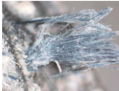
Figura A1.4 Material con amianto CROCIDOLITA (60 X)
