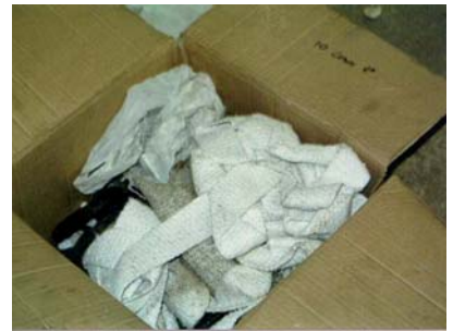
Figura A1.31 Tejidos de amianto (coquilla)
