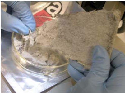
Figura A1.6 Material FRIABLE (panel)
