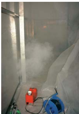
Figura A3.9 Control de la eficacia del confinamiento mediante una prueba de humo
