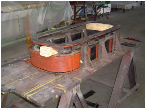
Figura A1.35 Aislamientos eléctricos en una bobina
