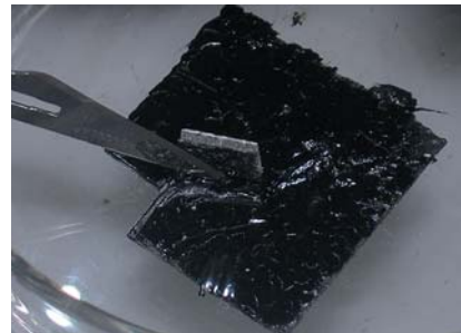
Figura A1.9 Material NO FRIABLE (tela asfáltica)
