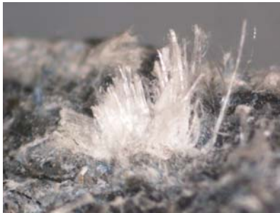
Figura A1.3 Material con amianto CRISOTILO (60 X)
